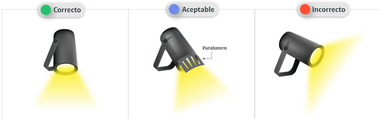
Figura 3.3.1.6 a. Control del flujo luminoso de proyectores. (Fuente propia)
