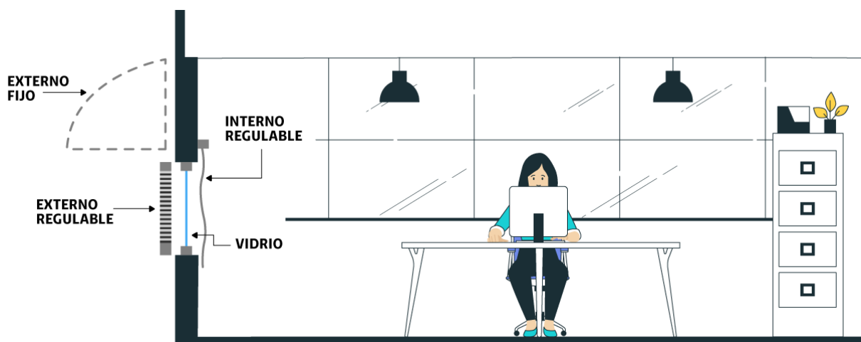
Figura 3.2.1.7. a. Ejemplo de dispositivos para controlar el ingreso de la luz diurna. (Fuente propia)
